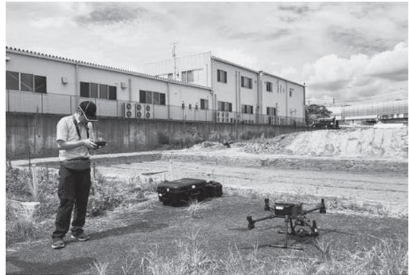
6. ドローンによる撮影および3D測量
